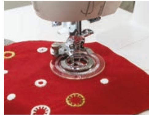
*Remarque : si vous utilisez une aiguille double, réglez la machine pour l'aiguille double ou ajustez la largeur de point sur 2 ou moins. Un entoilage peut s'avérer nécessaire pour empêcher le tissu de froncer.*
