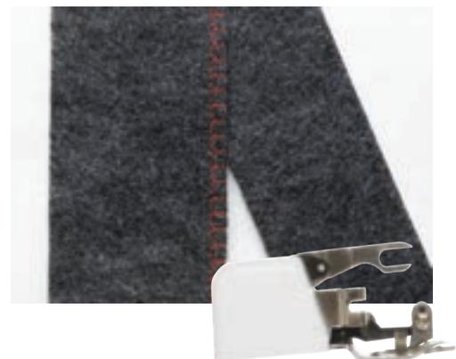
*Remarque : il se peut que vous deviez ajuster la tension de la machine ainsi que la longueur et la largeur de point en fonction du tissu.*
