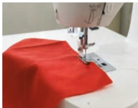
*Remarque :* le pied à roulotté peut aussi être utilisé pour coucher la laine ou avec des fils décoratifs. Introduisez l'extrémité des brins de laine dans le canal et dans la rainure située sous le pied. Réglez la machine sur un point zigzag ou décoratif, en ajustant la longueur et la largeur selon vos souhaits.
